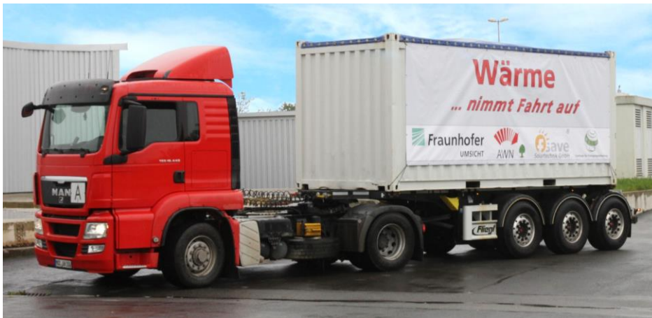
Bildquelle: Fraunhofer UMSICHT, Teilprojekt K des Forschungsverbundes Energieeffiziente Technologien und Anwendungen FORETA: „Mobile Wärmespeicherung zur Abwärmenutzung“
