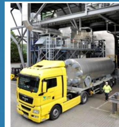
Abb. 1: Mobiler Sorptionswärmespeicher an der Ladestation (© MHB Hamm Be- treiber-gesellschaft)
