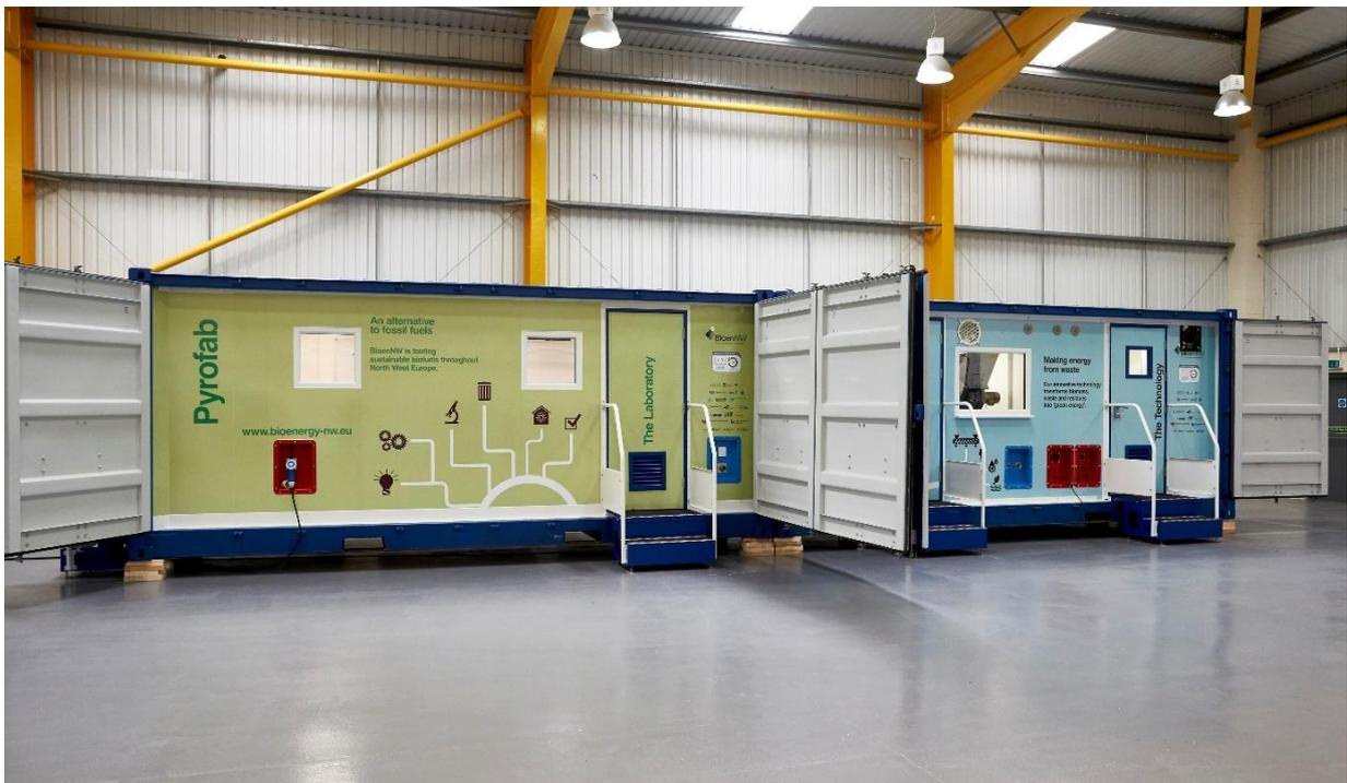
Abbildung 6: Der Pyrofab besteht aus 2 Containern: Einem Labor-Modul (grün) und einem Pyrolyse-Modul (blau)
