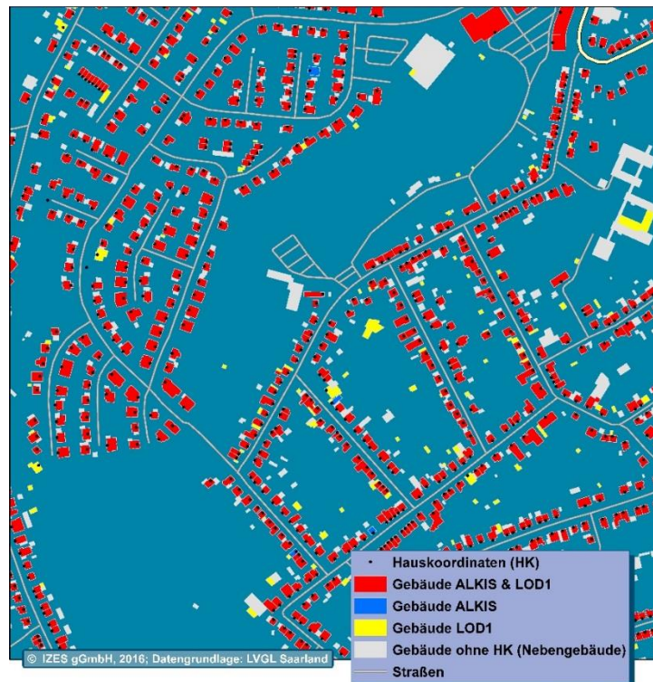
Abbildung 1: Überlagerung des ALKIS-Datensatzes und des 3D-Gebäudemodells
