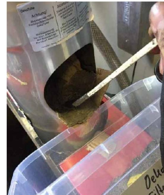
Probenahme an einer sekundären Emissionsminderungsmaßnahme an einem Stückholzkessel (Quelle: IZES gGmbH)
