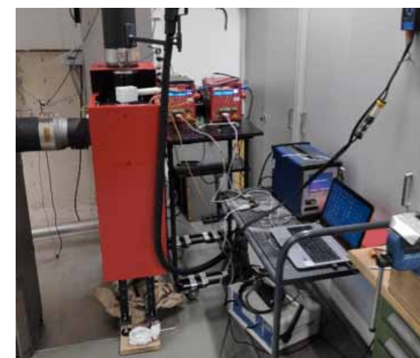
Abscheider Prototyp als nachgeschaltete Lösung an einer ERF (Quelle: IZES)
