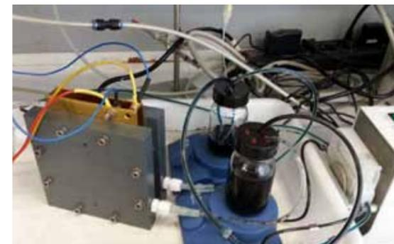
Laboraufbau zur Bestimmung des SoC des Elektrolyt (Quelle: Universität des Saarlandes)
